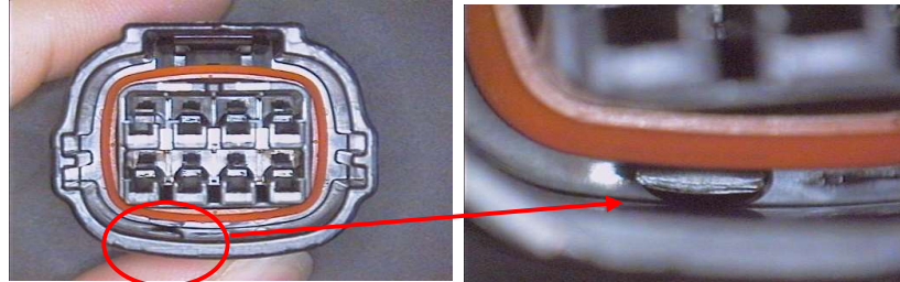
（パッキンの奥に異物が入り込んでいる）
